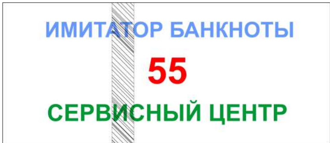
Рис.12 Пример тестового образца имитатора банкноты по ветхости с наличием на поверхности клеящей ленты
